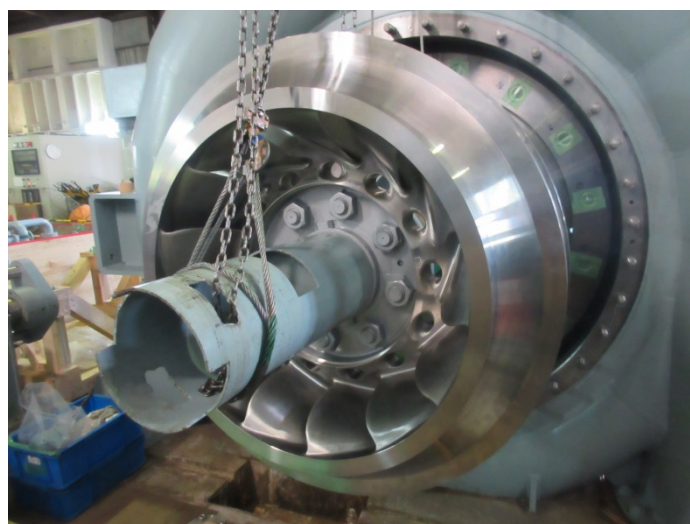
片貝第二発電所 水車羽根車（ランナ）
