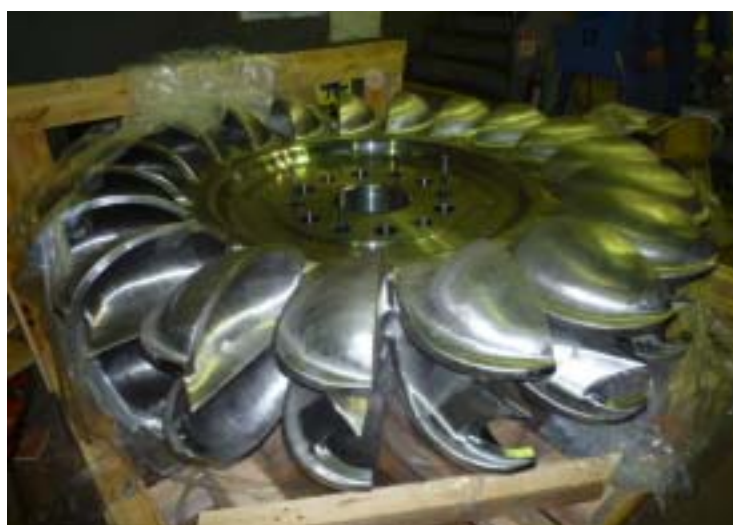
中崎発電所 水車ランナ
