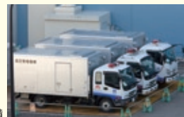
非常用電源車(300kVA)5台配備
