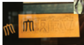
証書などに使われる「すかし」の道具。カットしたこの紙を置いたところだけ薄く漉ける
