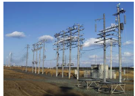
図 3 暴露試験設備 (福井県坂井市三国町)
