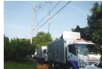
高圧発電機車による仮送電
