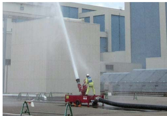
放水装置の操作訓練 放射性物質の拡散抑制や火災防護に使用する放水装置の操作訓練
