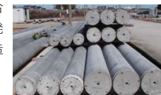
石炭灰の有効利用コンクリート柱
