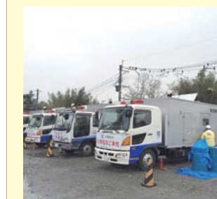
高圧発電機車4台による病院等への送電
