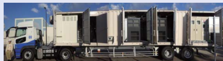
可搬型窒素供給装置の設置
