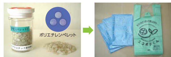
再生プラスチックのポリエチレンペレット 富山県認定リサイクル製品「エコポリくん」
