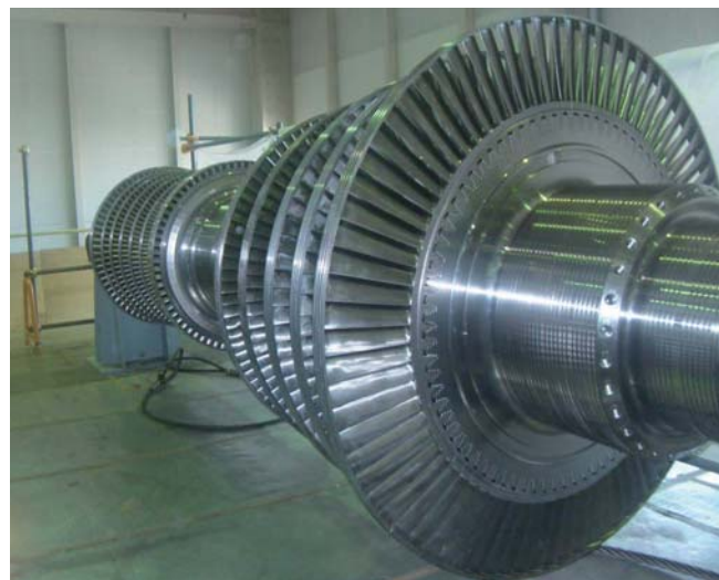
効率向上型タービンローター(敦賀火力発電所1号機)
