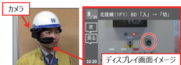
ウェアラブルカメラ・モニターによる遠隔支援検点例
